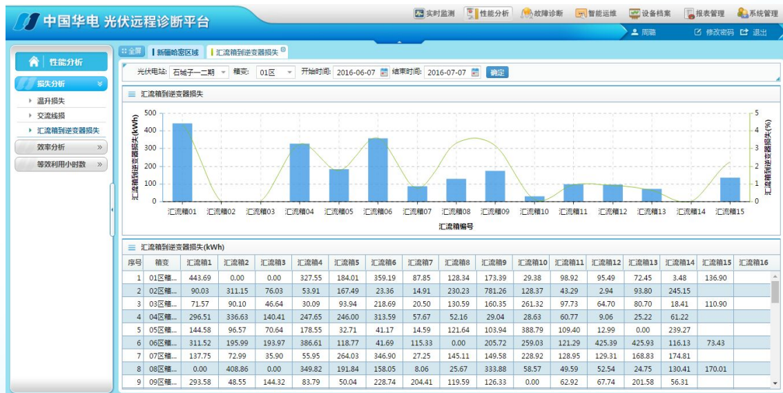
图7 汇流箱到逆变器损失界面
